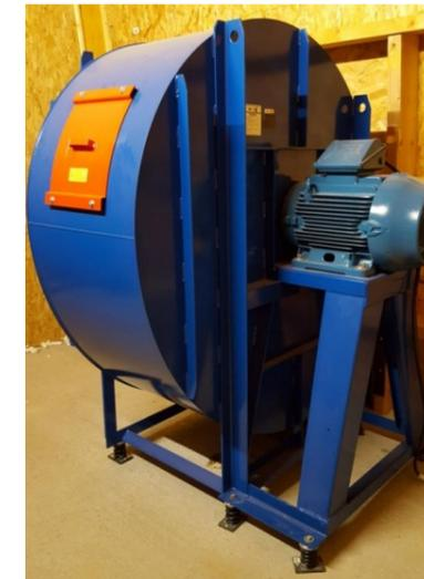
Figure 8 : Exemple de ventilateur centrifuge
