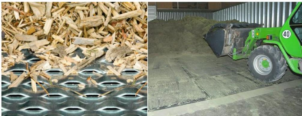
Figure 16 : Illustration du plancher de séchage
