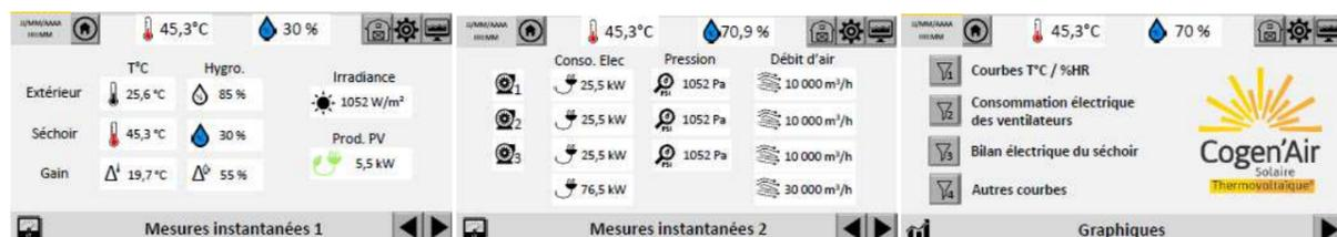
Figure 14 : Exemple d'écrans d'affichage d'une supervision avec option monitoring
