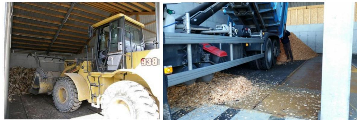
Figure 18 : Chargement et déchargement de la matière
